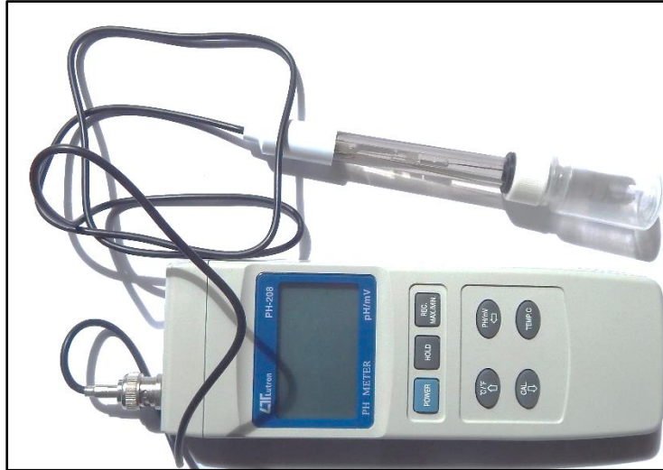
Figure 89 : pH-mètre (Digital Instrument PH-208©)
