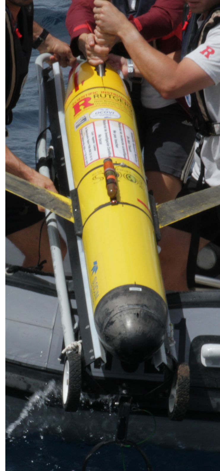
Déploiement d'un glider sous-marin pour le suivi acoustique des mammifères marins dans le Sanctuaire Agoa. © Etienne Jeannesson / Office français de la biodiversité
