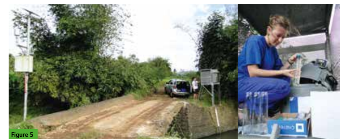
Figure 5 : Système de mesures : centrale d'acquisition de données (hauteur d'eau, T°, turbidité) et préleveur automatique d'échantillons d'eau de la rivière Galion pour l'analyse des matières en suspension et des teneurs en pesticides (photo Lesueur Jannoyer)
