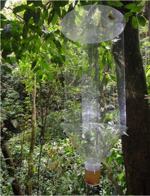
Piège Polytrap™. Suspendu dans un endroit favorable, il intercepte les insectes qui volent dans le milieu et qui tombent dans le pot collecteur rempli d'un liquide de conservation.
