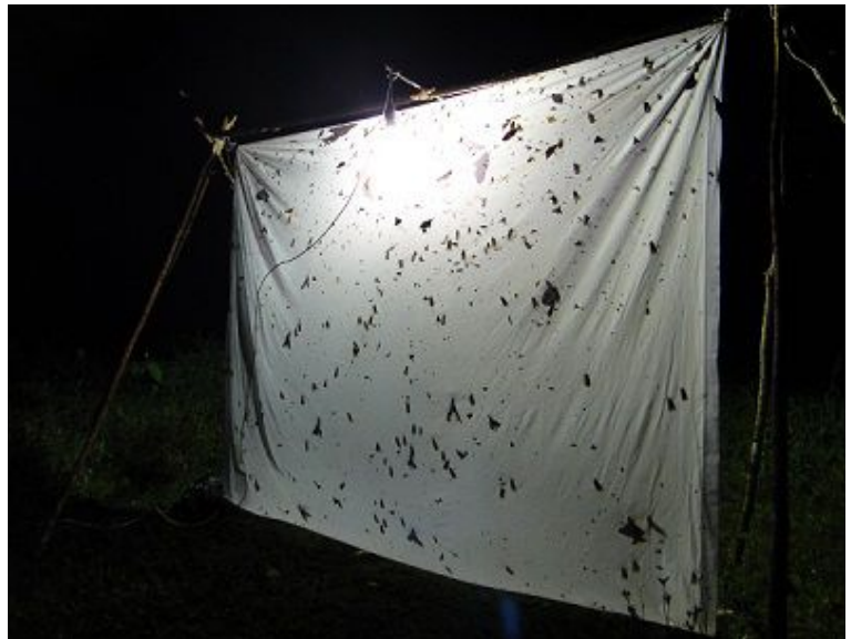
Piège lumineux fonctionnant sur groupe électrogène (Martinique, 2012). Les insectes attirés par une lumière puissante à fort spectre dans l'UV se posent sur le drap blanc.
